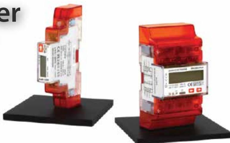
Misure disponibili : Corrente, Tensione, Potenza Attiva, Reattiva, Apparente, Energia totale e bidirezionale, Frequenza, Cosφ, Totalizzatori per ogni potenza bidirezionali, uscita impulsiva luminosa 50
